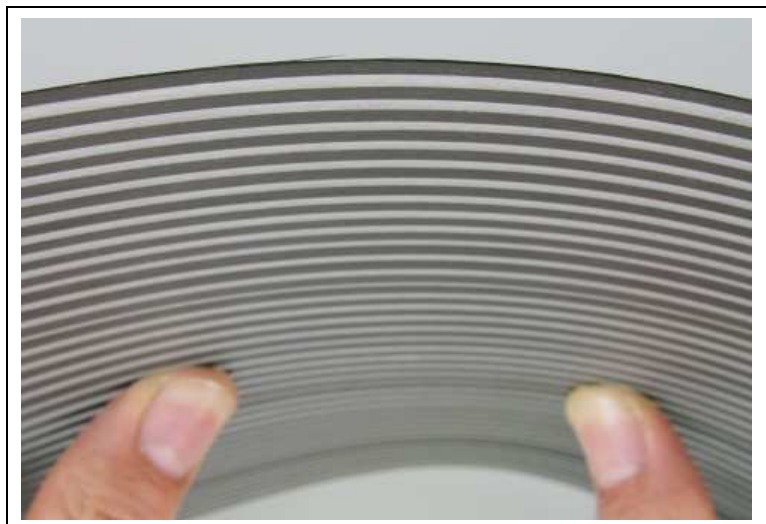
Figure 13 : Exemple de composite stratifié (fibres de verre et de carbone)
