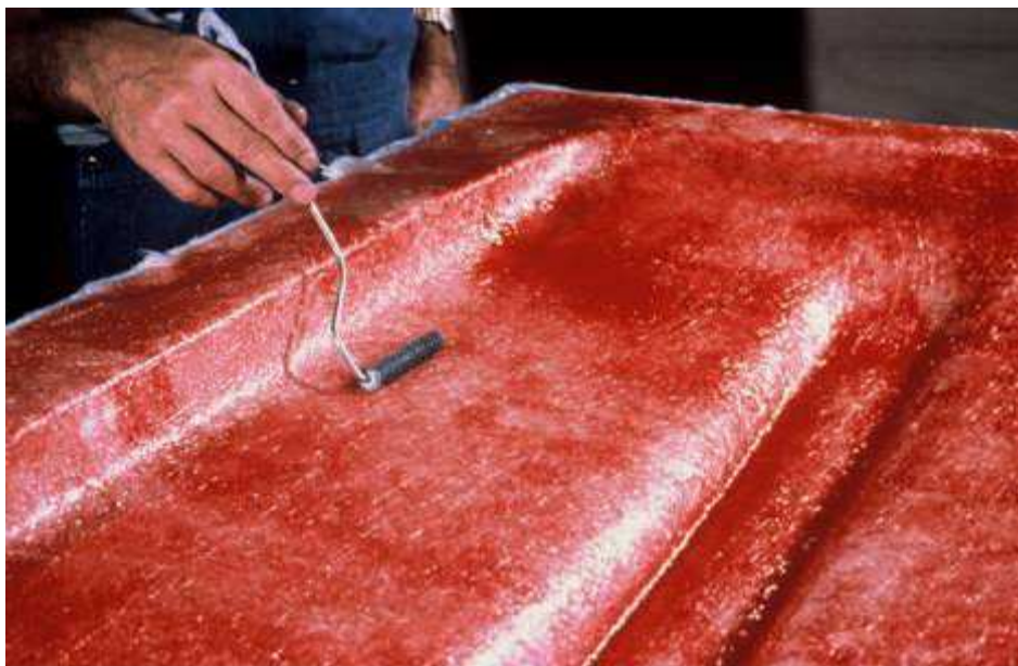
Composite fabriqué par moulage au contact (CARMA, 2006)
